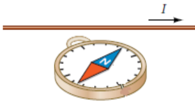
Рис. 17.2 – Взаємодія компаса і провідника із струмом
